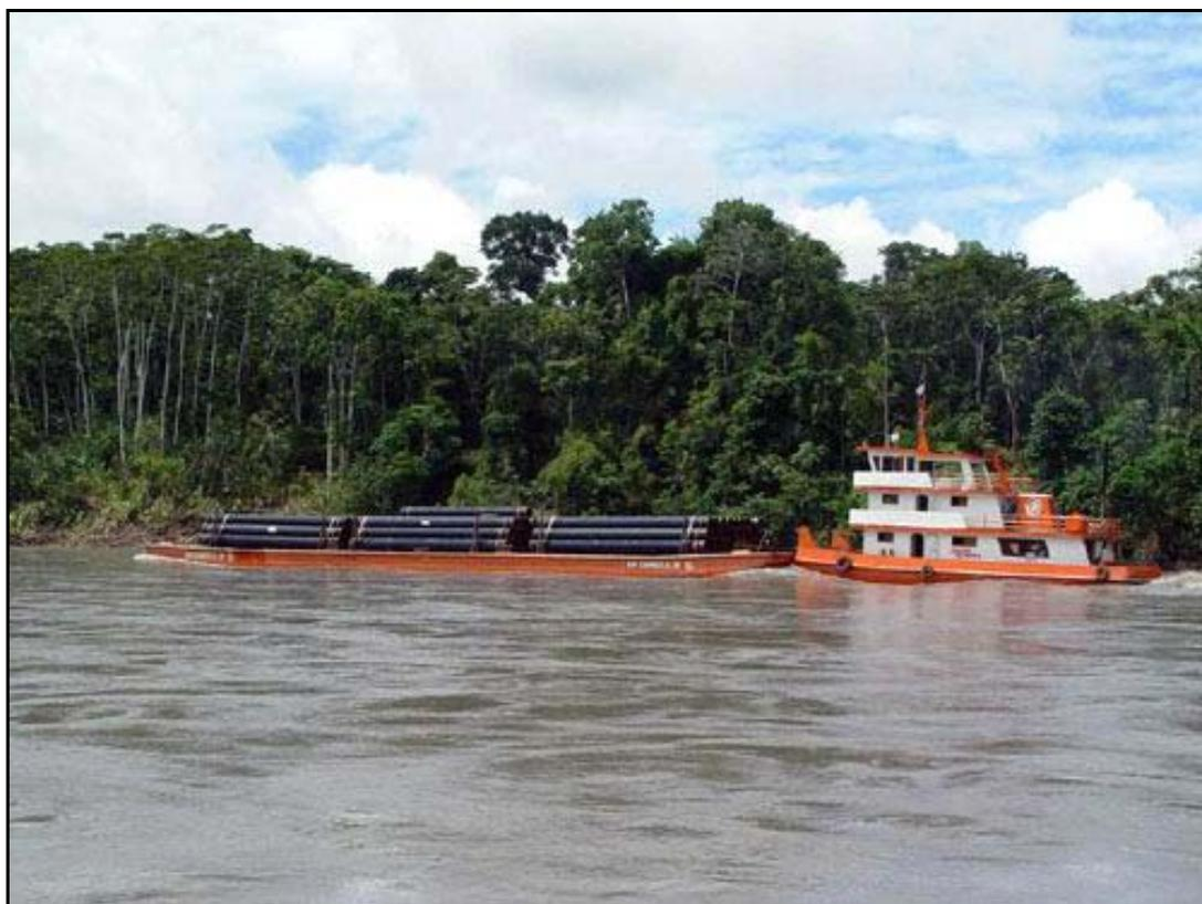
**Fotografía 6.1.6 Empujador fluvial transportando un artefacto fluvial (barcaza) navegando por el río Ucayali con tubería para operaciones petroleras.**
